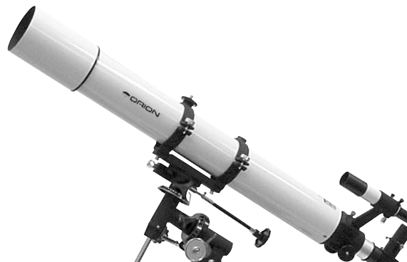
Figura 3a. Equilibrado del telescopio con respecto al eje de A. R. deslizando el contrapeso a lo largo de su eje.
