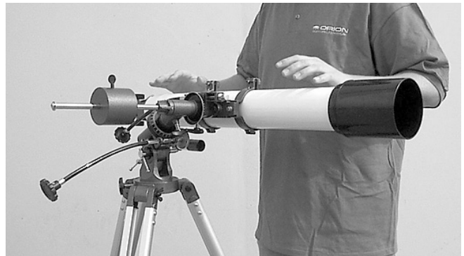
Figura 3e. El telescopio está ahora equilibrado sobre el eje de declinación, es decir, se mantiene en posición horizontal cuando se sueltan las manos.
