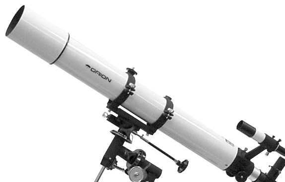
Figura 3a. Bilanciamento del telescopio rispetto all'asse dell'ascensione retta facendo scorrere il contrappeso sulla sua barra.
