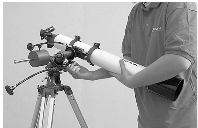
Abbildung 3c. Vorbereiten des Teleskops auf das Ausbalancieren auf der Dek-Achse. Zuerst muss die Dek-Arretierschraube gelockert werden.
