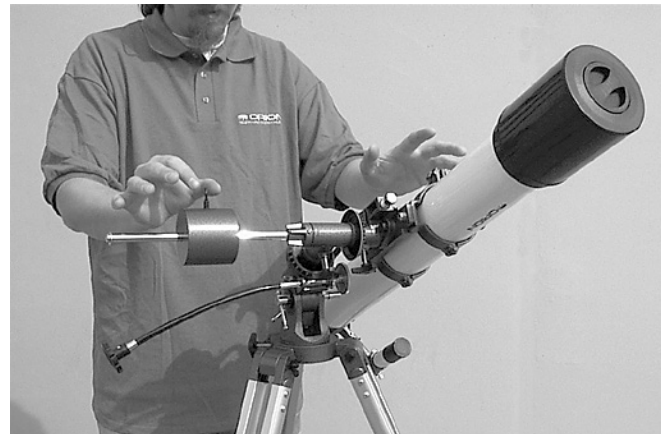
Abbildung 3b. Das Teleskop befindet sich nun auf der RA-Achse in optimaler Balance. Das heißt, dass die Gegengewichtsstange auch dann horizontal bleibt, wenn das Teleskop nicht mehr gehalten wird.
