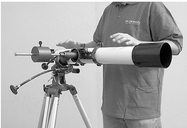
Abbildung 3e. Das Teleskop ist nun auf der Dek-Achse ausbalanciert, d. h. es bleibt auch dann in der Waagerechten, wenn es nicht mit der Hand gestützt wird.
