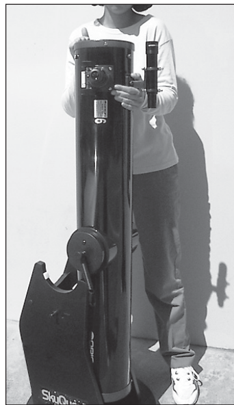
Figure 3. Positionnez le tube optique dans le « berceau » de la base de façon à ce que les paliers latéraux d'altitude du tube s'appuient sur les « tampons » blancs en plastique, et le viseur et le panneau avant soient dos à dos (Partie B).
