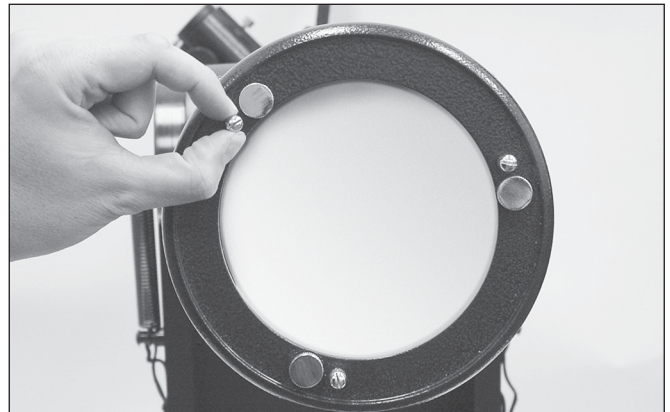
Figure 16. Les trois petites vis de serrage qui verrouillent le miroir principal en position doivent être desserrées avant de procéder à tout ajustement.
