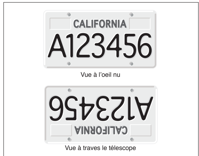
Figure 11. La vue à travers un télescope réflecteur est à l'envers.
