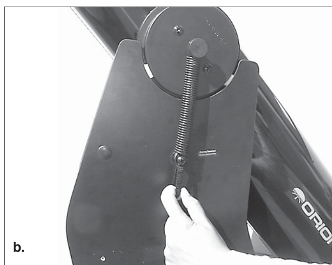
Figure 8. (a) Pour attacher le ressort à la base, tenez l'anneau à tirer avec votre index et tirez le ressort. (b) Tout en tirant vers le bas, glissez l'anneau finale du ressort sur la tête du boulon et dans la partie étroite de l'entretoise en nylon, puis lâchez l'anneau à tirer.
