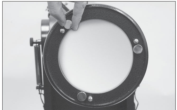
Figure 17. L'inclinaison du miroir principal est ajustée en tournant une ou plusieurs des trois vis de serrage plus grosses.
