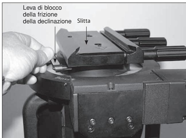
**Figura 20:** iniziare con la slitta a coda di rondine nella posizione predefinita, che punta dritto.
