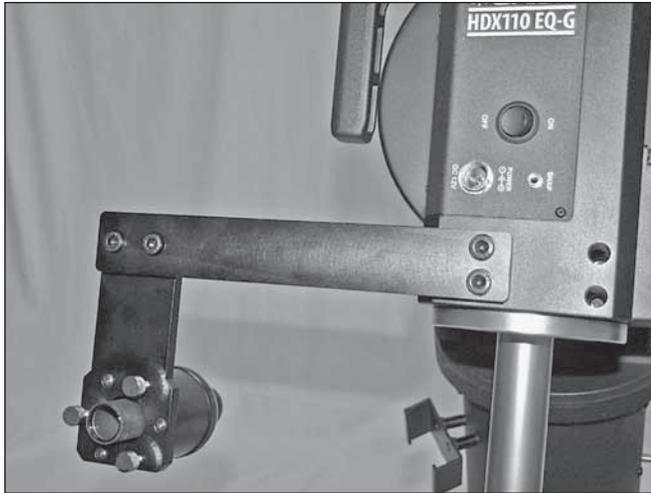
**Figura 16.** Cercatore polare opzionale installato sulla montatura HDX110.
