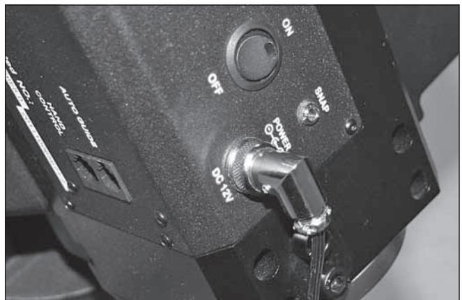
**Figura 18.** Il connettore ad angolo retto del cavo di alimentazione a 12 VCC incluso si avvita al connettore di alimentazione della montatura.
