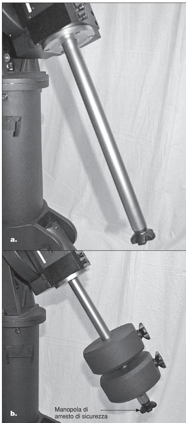
**Figura 13. (a)** La barra di contrappeso si avvita nella montatura. **(b)** Installare i contrappesi e riposizionare la manopola di arresto di sicurezza.
