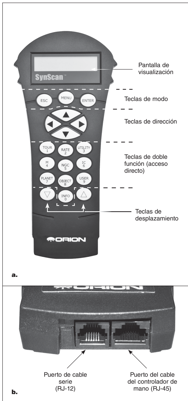
Figura 1. a) Controlador de mano SynScan GoTo, b) Cable del controlador de mano y puertos de cable serie en el extremo inferior del controlador
