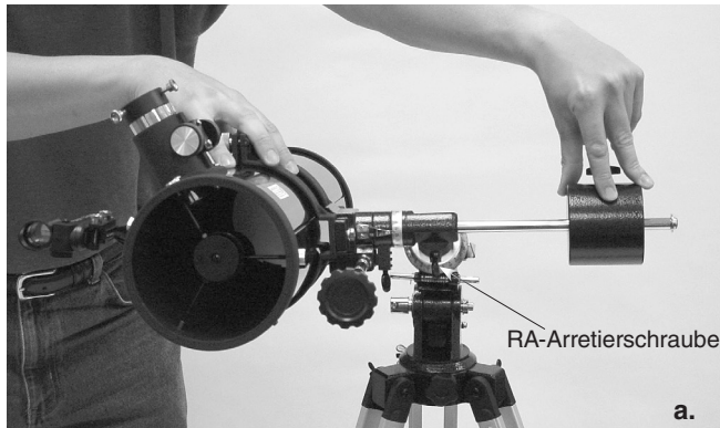
Abbildung 4. Um eine ordnungsgemäße Funktionsweise der parallaktischen Montierung zu gewährleisten, muss das Optikrohr des Teleskops sowohl auf der RA- als auch der Dek-Achse optimal ausbalanciert sein. (a) Lockern Sie die RA-Arretierschraube, und schieben Sie das Gegengewicht so an der Gegengewichtsstange entlang, dass ein perfektes Gleichgewicht mit dem Optikrohr herrscht. Wenn Sie die Hände nun vom Teleskop nehmen, sollte sich das Optikrohr von selbst nicht mehr nach oben oder unten bewegen. (b) Lockern Sie die Dek-Arretierschraube und die Rändelschrauben der Rohrschellen um einige Umdrehungen, und schieben Sie das Teleskop in den Rohrschellen je nach Bedarf vor oder zurück. Wenn das Optikrohr auf der Dek-Achse optimal ausbalanciert ist, wird es seine Position auch dann beibehalten, wenn Sie die Hände vom Teleskop nehmen
