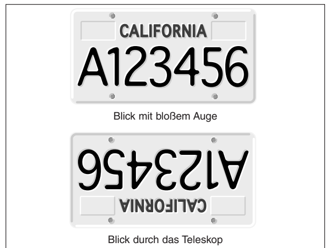
Abbildung 8. Beim Blick durch ein Spiegelteleskop ist das sichtbare Bild um 180° gedreht.
