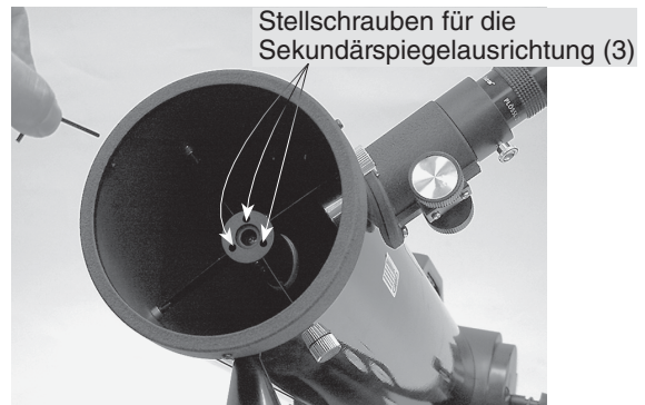
Abbildung 14. Stellen Sie die Neigung des Sekundärspiegels ein, indem Sie jeweils eine der drei Stellschrauben für die Sekundärspiegelausrichtung lockern und die beiden anderen anziehen..
