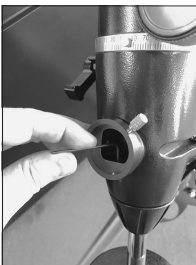
Figura 3. Serrare le due viti di fermo usando la chiave a brugola inclusa. Dato che non c'è molto spazio per manovrare la chiave, potrebbero essere necessari più giri.
